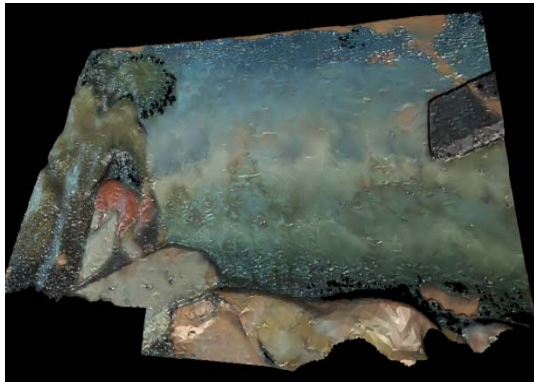
Figura 7: Muestras alineadas mediante el algoritmo propuesto. Los parámetros usados han sido: n_0 = 50 , \tau_c = 0.3 , \tau_{err} = 1 \times 10^{-3} .
